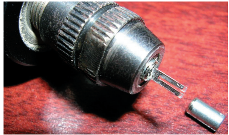
Figure 2 : Gauche : mesure du courant traversant un diapason encapsulé puis décapsulé en fonction de la fréquence : on observe la résonance suivie de l'antirésonance en amplitude. Noter la chute du maximum du signal et l'élargissement du pic dus aux frottements visqueux avec l'air une fois le diapason décapsulé. Droite : un résonateur, monté sur une perceuse de modélisme, vient d'être décapsulé.
